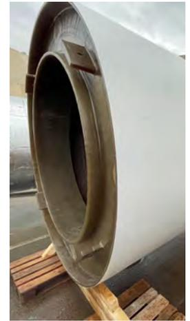
Bilder 8 bis 10: GFK-Inliner von innen / Transport der Segmente / Inliner mit Isolierung und Tropfenfang
