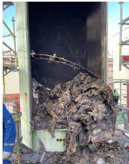
Bilder 3 a und 3 b: Reste verbrannten GFKs und Isolierung am Rauchgaseintritt
