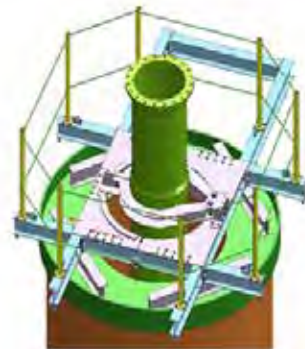
Bild 9: gleiche Konstruktion wie Bild 8, nach Umbau, für die Abfangung und Montage des neuen Abgasrohres
