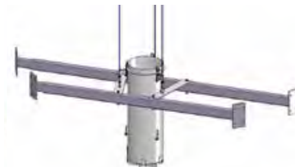
Bild 6: Illustrierung modulare Teil-Ring-Arbeitsbühne
